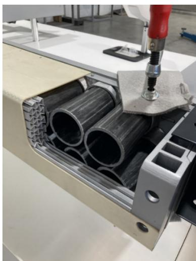
**Abb. 2** Der Schweller aus Crash-Absorbern in Form von Faser-Kunststoff-Verbund (FKV)-Röhren und einem Pufferelement als auxilliäre Struktur aus Polyurethan bietet sowohl Schutz für die Fahrzeuginsassen als auch für den Energieträger – Batterie oder Wasserstofftank.
