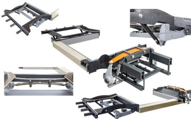
**Abb. 1** Mit einem kreislaufgerechten Open-Source-Baukasten können die einzelnen Komponenten über mehrere Fahrzeullebenszyklen hinweg verwendet werden.
